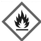
Cet appareil contient du gaz réfrigérant R32 inflammable. Il ne faut jamais utiliser un autre gaz réfrigérant. Tout autre corps gazeux mélangé avec le R32 risque de provoquer des pressions anormalement élevées pouvant conduire à une panne ou à une rupture de tuyaux, et blesser des personnes.
